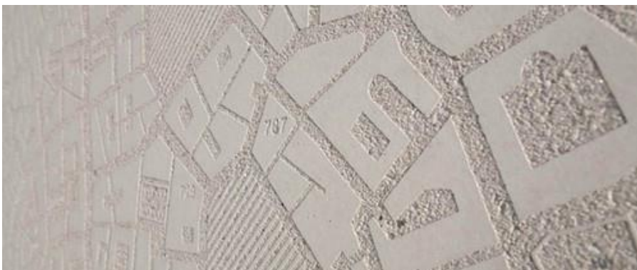
Рис. 27 – Рельеф «графического бетона»
