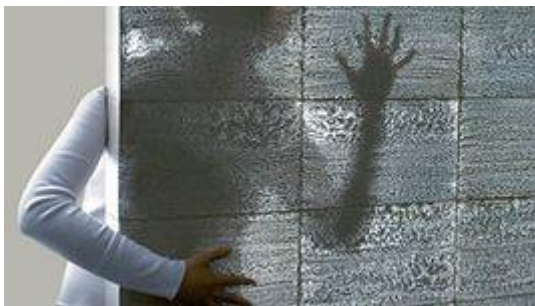
Рис. 40 – Вид блоков из «прозрачного бетона»
