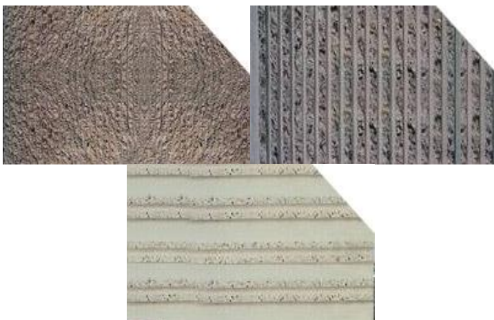
Рис.34 – Бетонная поверхность, обработанная методом отбивания или откалывания
