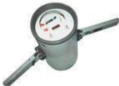
Рис. 4. Прибор АГАМА – 2РМ для ускоренного определения водонепроницаемости бетона
