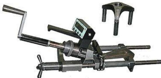
Рис. 10. Измеритель прочности бетона методами скалывания ребра и отрыва со скалыванием ПОС-50МГ4
