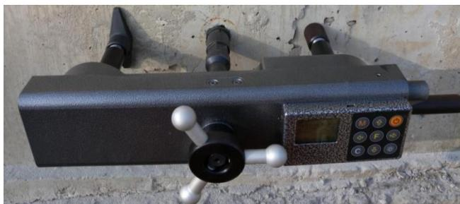
Рис. 8. Измеритель прочности бетона методом отрыва со скалыванием «ОНИКС – ОС»
