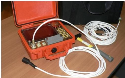
Рис. 15. Измеритель длины свай ИДС-1
