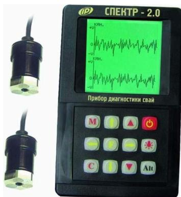
Рис. 19. Прибор диагностики свай «СПЕКТР - 2.0»
