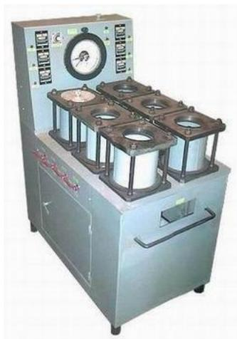
Рис. 3. УВФ-6 – установка для оценки водонепроницаемости и фильтрации бетона без форм
