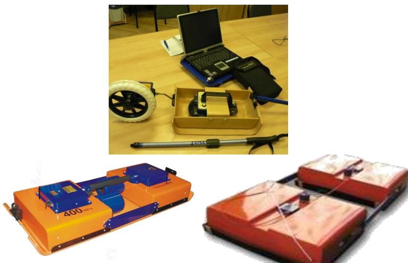
Рис. 12. Георадиолокатор (георадар) ОКО – 2 с антенными блоками
