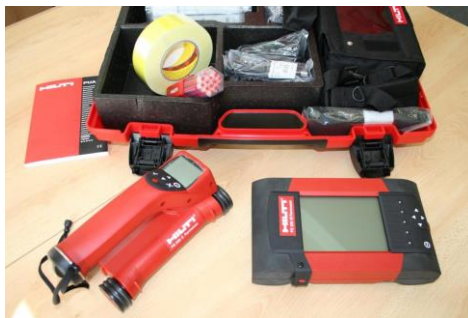
Рис. 21. Прибор «Система Ферроскан PS 200»
