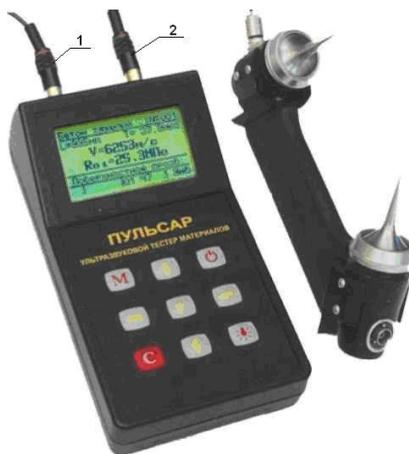
Рис. 3. Прибор "Пульсар – 1.0"
