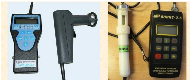
Рис. 7. Электронные измерители прочности бетона методом ударного импульса ИПС-МГ4 и ОНИКС – 2,5
