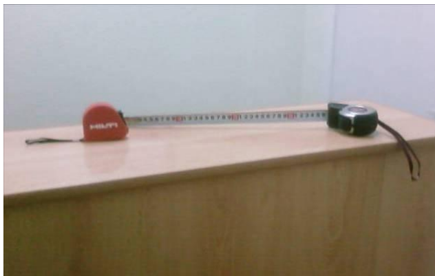
Рисунок 13. Рулетка измерительная металлическая II класса по ГОСТ 7502 для определения геометрических размеров конструкций
