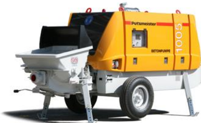
Рисунок 1 - Стационарный бетононасос Putzmeister BSA 1005 D / E
