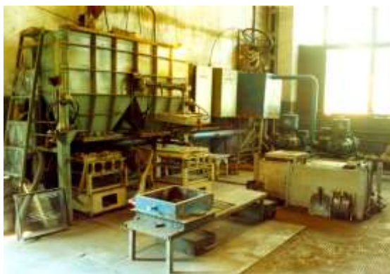
Литье по методу вакуумно-пленочной формовки
