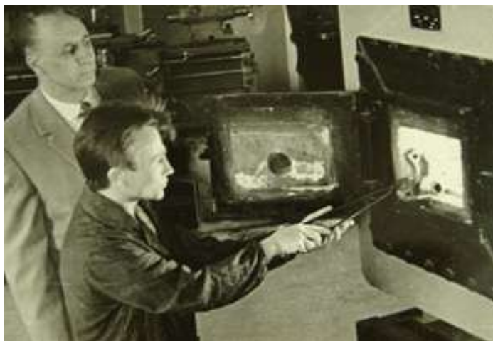
Студент Анатолий Сучков и зав. кафедрой металловедения И.И. Хорошев проводят эксперимент по термической обработке детали
