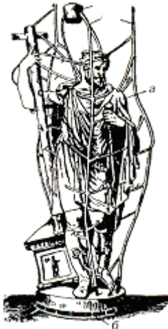
Рис. 155. Литниковые и газоотводящие системы на модели: 1 - короля Людовика XV; 2 - князя Владимира; 3 - Минина и Пожарского: а - восковая модель; б - каналы для удаления воска; в - литниковая чаша; г - вентиляционные каналы; д -литниковые стояки
