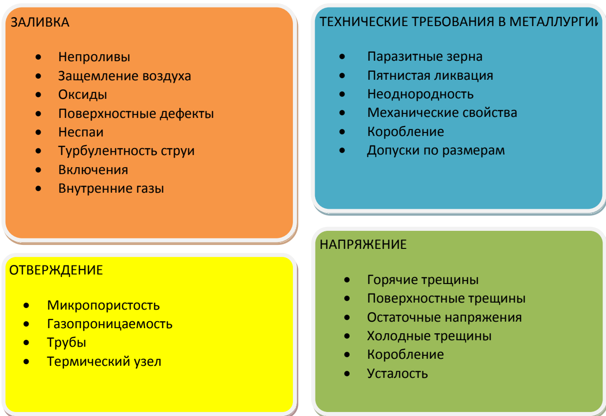
Рис. 2.4 – Возможности программы ProCAST по моделированию дефектов литья [4]
