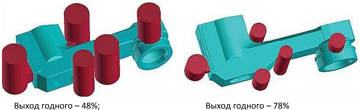
Рис. 3.1 – Оптимизация прибылей на стальной отливке «Рычаг»
