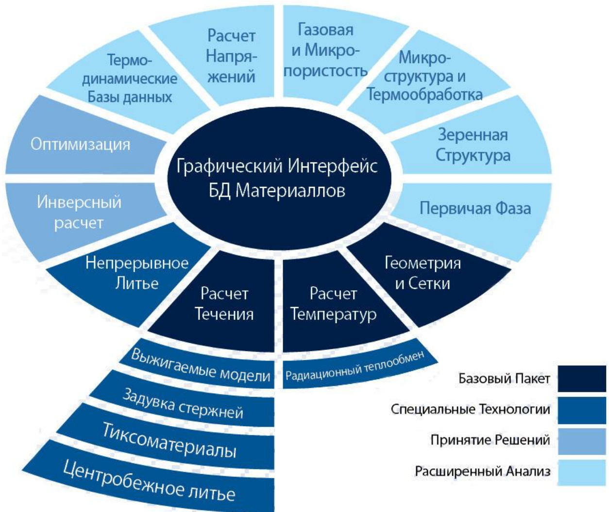
Рис. 2.3 - Модульная структура СКМ ЛП ProCAST [3]
