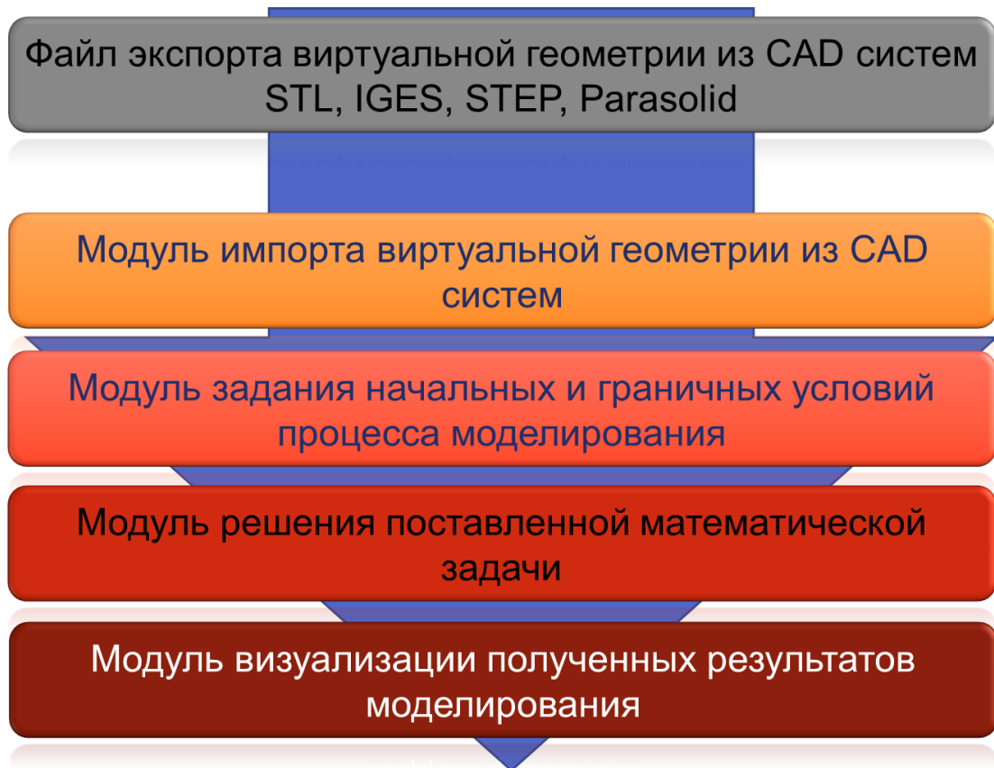
Рис. 2.6 - Обобщенная структура модульной компоновки СКМ ЛП
