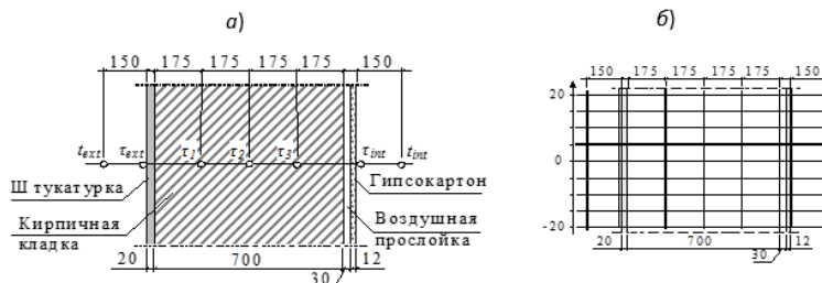
Рис. 2. Конструктивное решение наружной стены (а) и схема для построения линии распределения температур (б)
