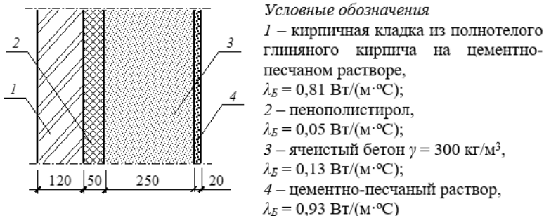
Рис. 1. Конструктивное решение наружной стены
