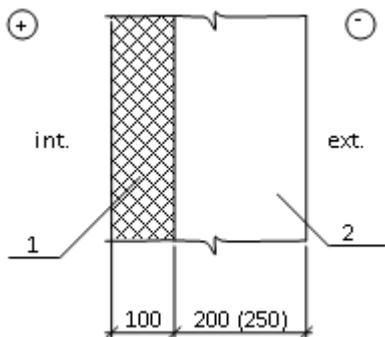
д) конструкция наружной стены для задачи 7
