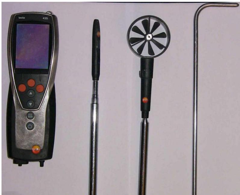
Рисунок 5 – Прибор testo-435 с набором зондов
