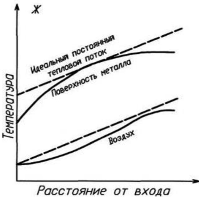
Рис. 6. Распределение температуры вдоль оси типичных поверхностей теплообмена: косинусоидальная форма распределения плотности теплового потока в осевом направлении при равномерной загрузке делящегося материала.
