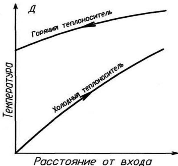
Рис. 4 Распределение температуры вдоль оси типичных поверхностей теплообмена в противоточном теплообменнике.
