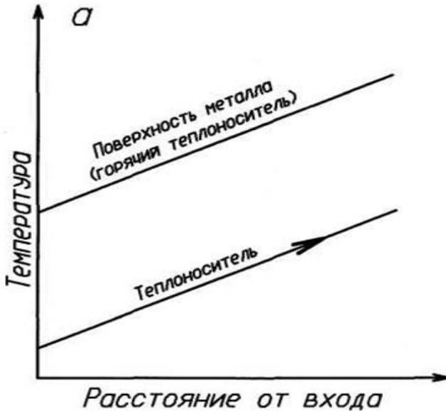
Рис. 1 Распределение температуры вдоль оси типичных поверхностей теплообмена при одинаковой разности температур или одинаковом тепловом потоке.
