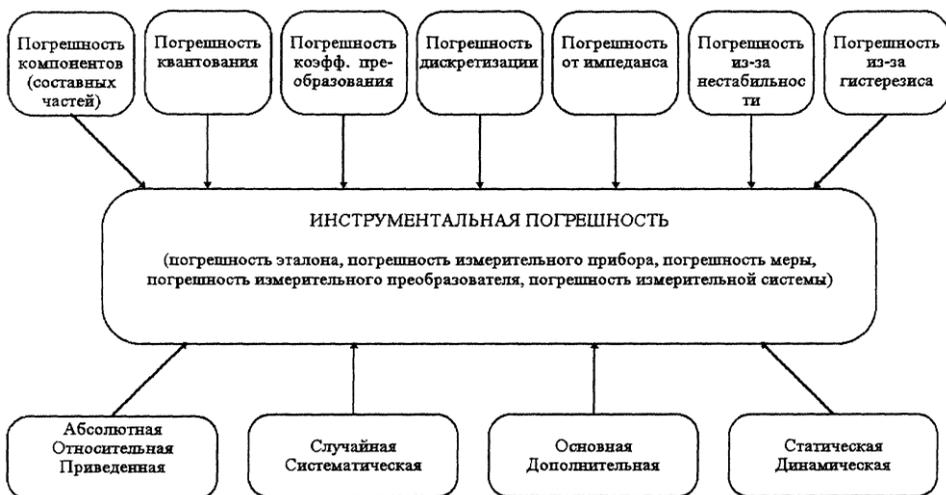
Рис.1. Структурная схема погрешностей измерения
