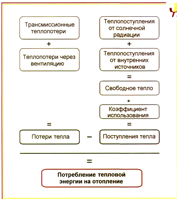
Рис. 2.16. Принцип энергобаланса помещений здания
