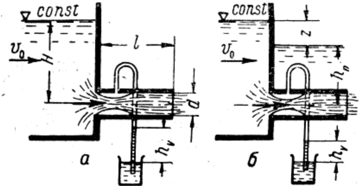
Внешний цилиндрический насадок чаще всего делается длиной от  $L = 3,5..4 d$ . При такой длине насадка в начале его (непосредственно за входом струи) образуется сжатое сечение, а в конце насадка жидкость вытекает полным сечением, т.е. коэффициент сжатия отнесенный к выходному сечению насадка, равен 1:
