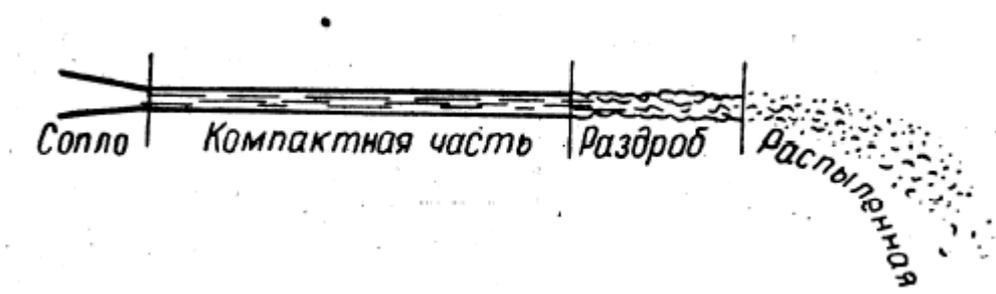
1. Компактную часть. Здесь сохраняется сплошность потока с цилиндрической (или близкой к ней) формой сечения.
