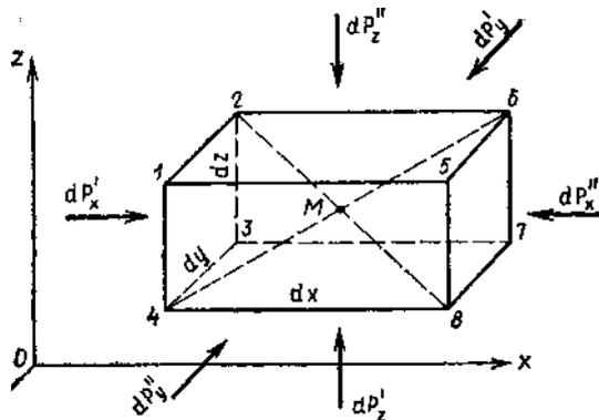
Со стороны окружающей среды на выделенный параллелепипед действуют :
