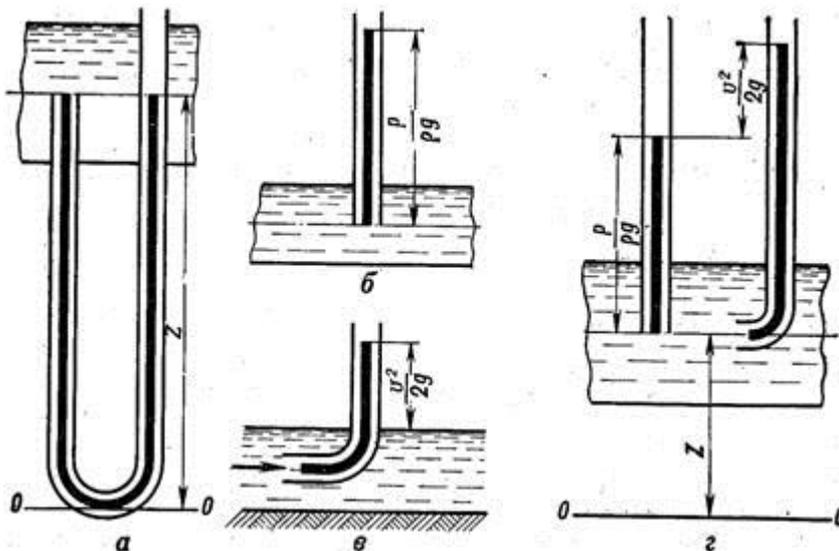
Рис. Виды напора жидкости: а – геометрический напор; б – пьезометрический напор; в – скоростной напор в открытом потоке; г – виды напора в трубопроводе. Второй член  $h_p = \frac{p}{\gamma}$  - это пьезометрическая высота или пьезометрический напор.
