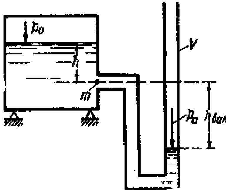
$h_{\text{вак}}$  - вакуумметрическая высота или высота вакуума.
