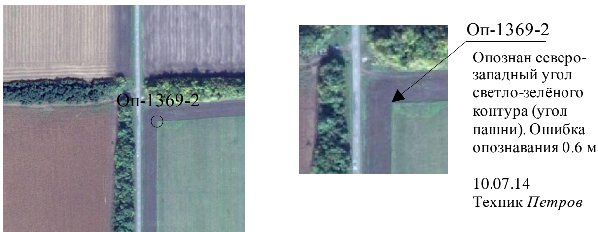
Рис. 2. Оформление опорной точки на аэрофотоснимке
