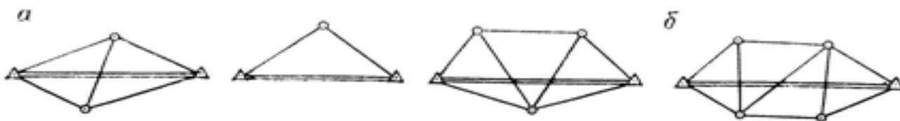
Рисунок 1. Схемы привязки геодезических сетей к сторонам (а) и пунктам (б) триангуляции высшего класса
