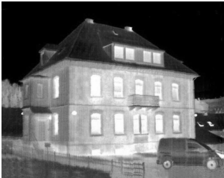
Рис. 7.9. Температурные поля фасада здания, зарегистрированные тепловизором
