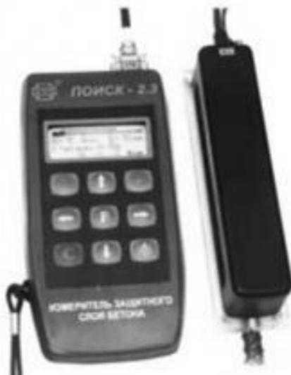
Рис. 9.7. Измеритель защитного слоя бетона ПОИСК-2.3
