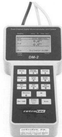
Рис. 8.2. Стенд для определения воздухопроницаемости ограждающих конструкций
