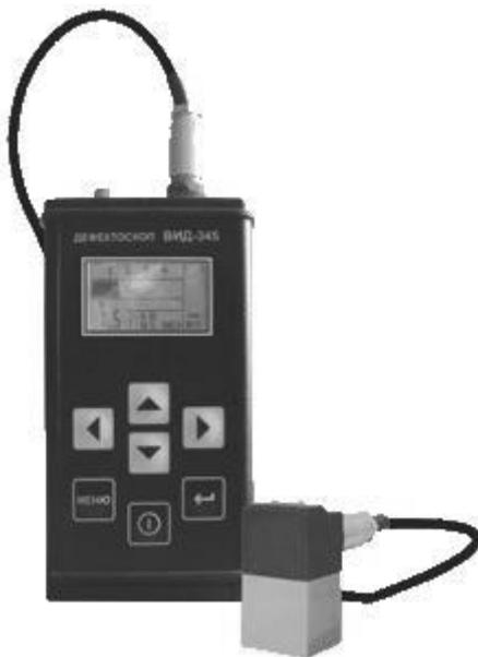
Рис. 5.5. Магнитно-вихретоковый дефектоскоп ВИД-345
