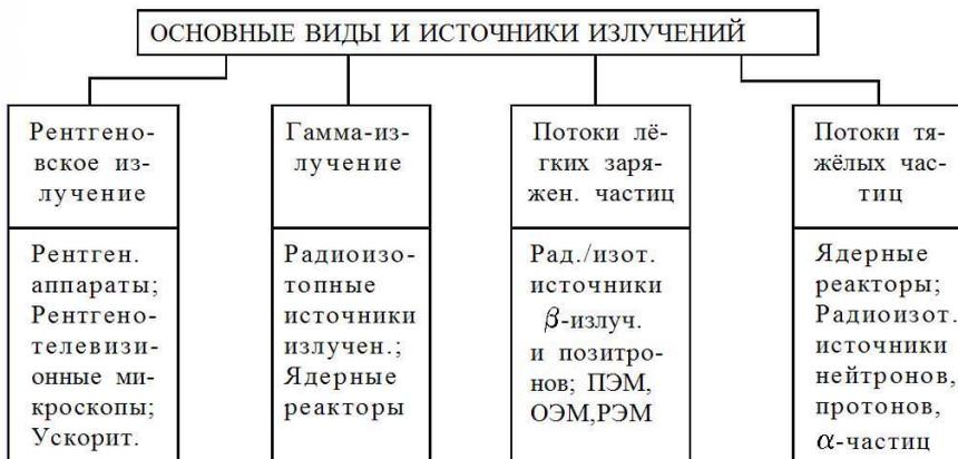
Рис. 6.1. Разновидности ионизирующих излучений, используемых в РНК
