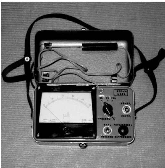
Рис. 7.4. Термометр ЭТП-М
