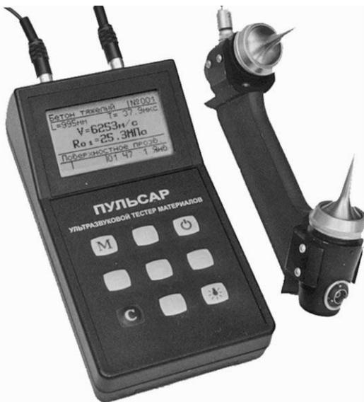
Рис. 9.5. Измеритель универсальный ультразвуковой ПУЛЬСАР-1.0
