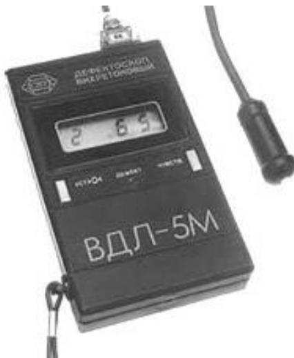
Рис. 9.6. Дефектоскоп вихретоковый ВДЛ-5М
