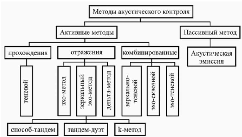
Рис. 4.1. Классификация акустических методов контроля
