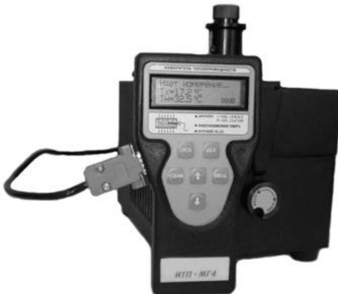
Рис. 9.3. Измеритель теплопроводности ИТП=МГ4
