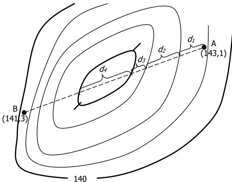
Рис. 10 Измерения по карте для построения продольного профиля
