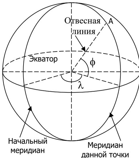
Рис. 3 Географическая система координат
