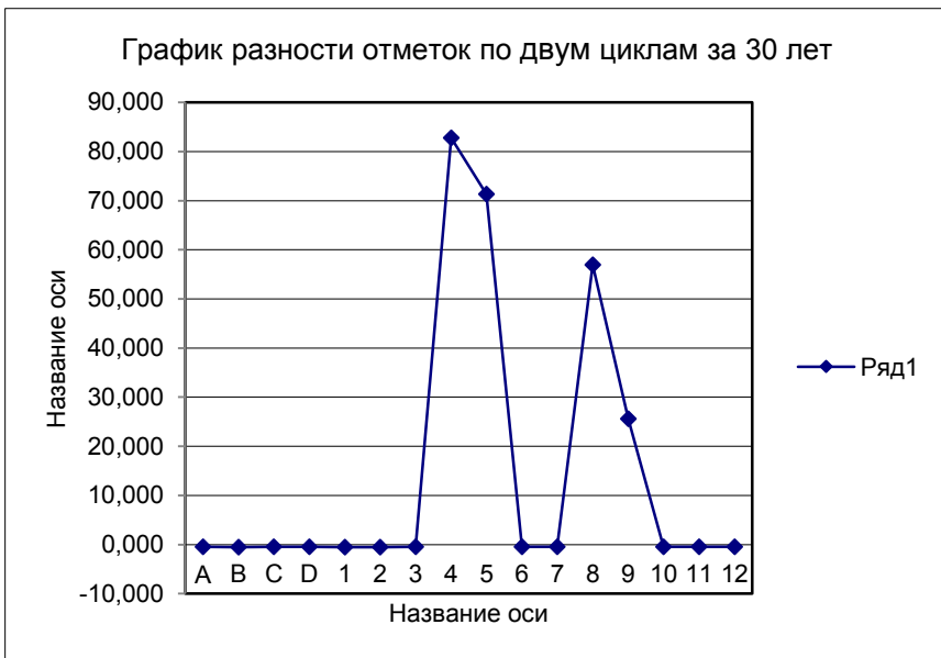
Рис.18. График разности отметок реперов за 30 лет
