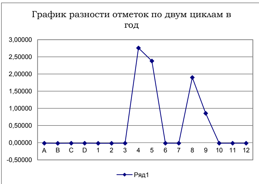
Рис.17. График разности отметок реперов за 1 год
