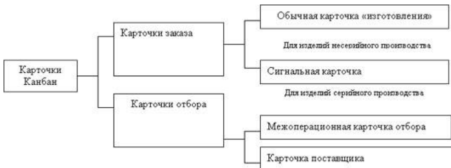
Рисунок 7 – Система "Канбан" с двумя каночками
