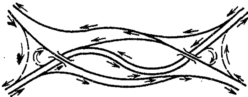
Рисунок П.3 – Схема линейного типа пересечения с двумя путе- проводами
