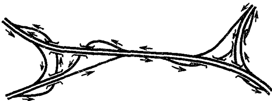
Рисунок П.3 – Схема линейного типа пересечения с двумя путе- проводами
