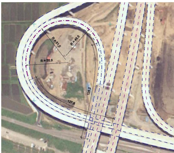
Рис. 20 – Восстановление геометрии транспортной развязки строящейся в окрестностях г. Токио
