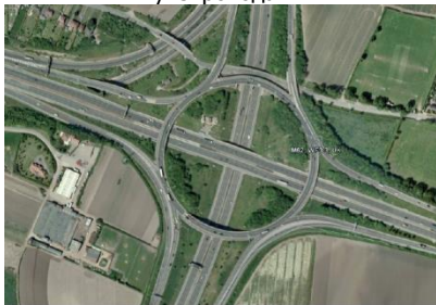
Кольцевое пересечение в разных уровнях на пересечении автомобильных дорог М62 и М1 в Англии, выполненное по типу распределительного кольца с пятью
