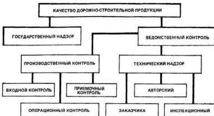
Рис. 5. Схема организации контроля качества дорожно-строительной продукции
