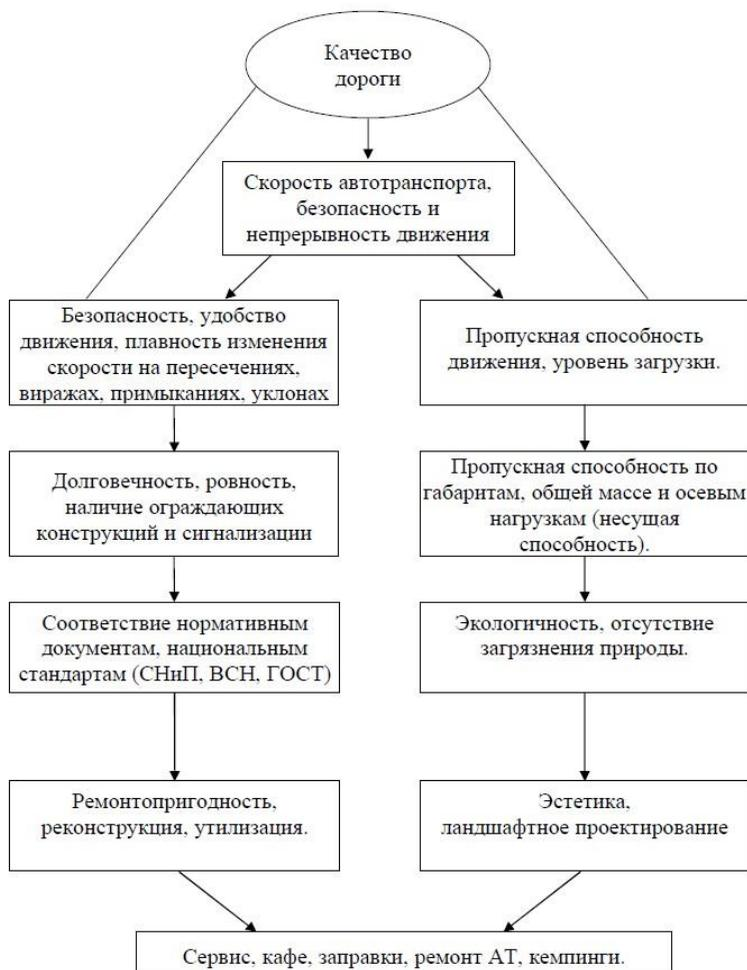
Рис. 1 Основные составляющие, обеспечивающие высокое качество дороги
