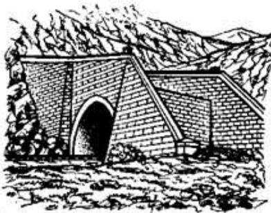
Рис. 1.3. Двухочковая водопропускная труба
