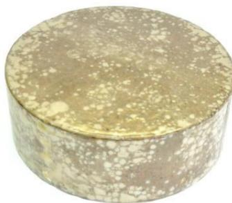
Рисунок 3.5 – Грунтовый образец обработанный парафином
