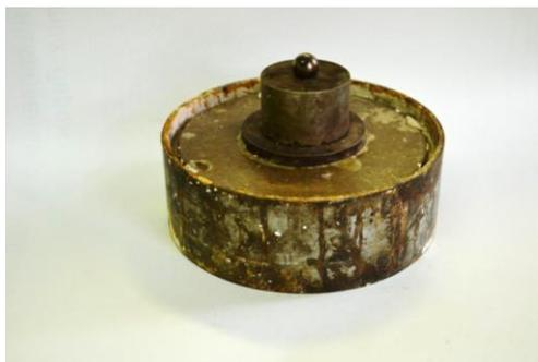
Рисунок 3.7 – Грунтовый образец в стальной форме бокового обжатия с приложенным штампом
