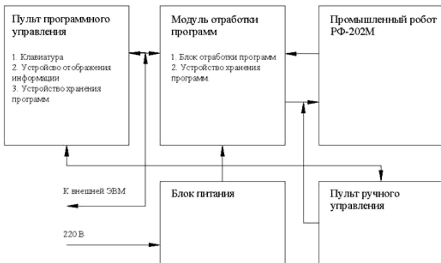
Рисунок 5. Структурная схема управления роботом.
