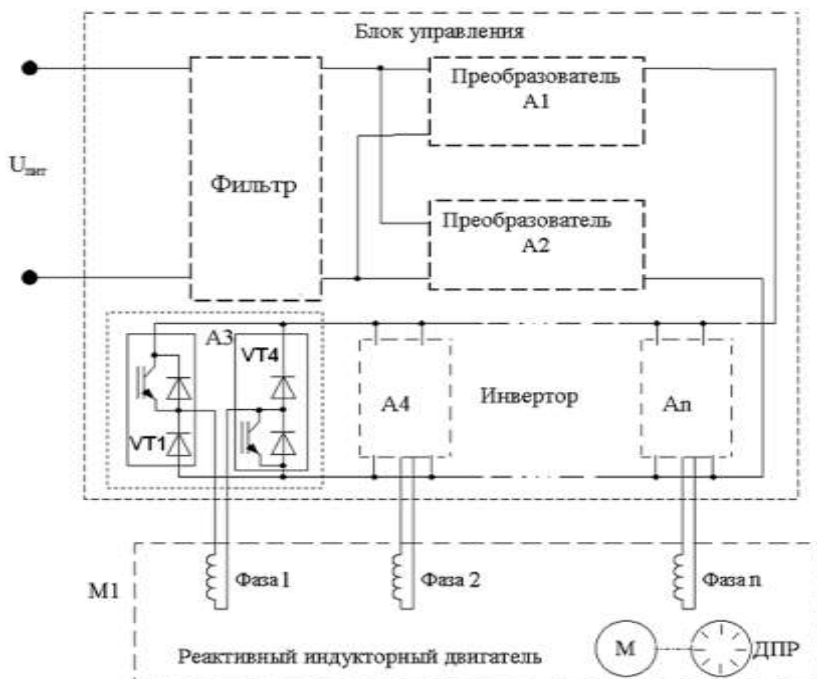
Рис. 2.22. Силовая схема управления вентильно-индукторным двигателем
