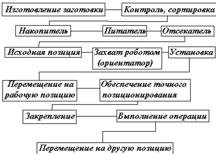
Рисунок 1. Состав микроэлементарных перемещений
