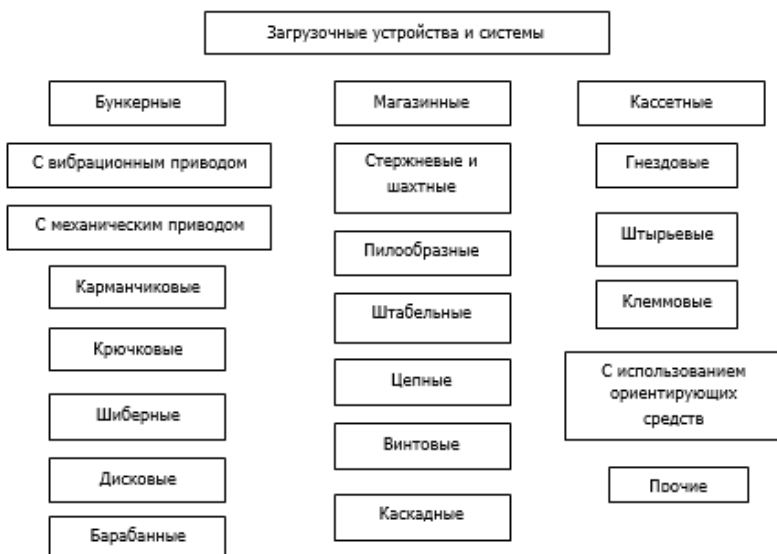
Рис. 38. Классификация загрузочных устройств
