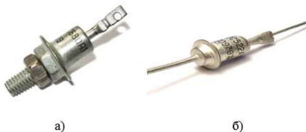
Рис. 2.6. Общий вид стабилитронов КС680АП (а) и КС522А (б)
