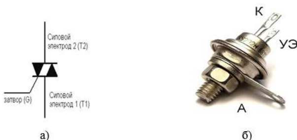
Рис.2.47. Внутренняя схема симистора КУ126А (а) и внешний вид тиристора КУ202Н (б)
