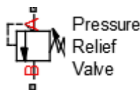
Рисунок 23 - Предохранительный клапан
