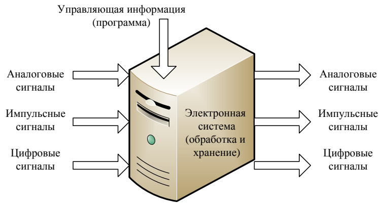
Рис. 1.2. Программируемая (микропроцессорная) электронная система
