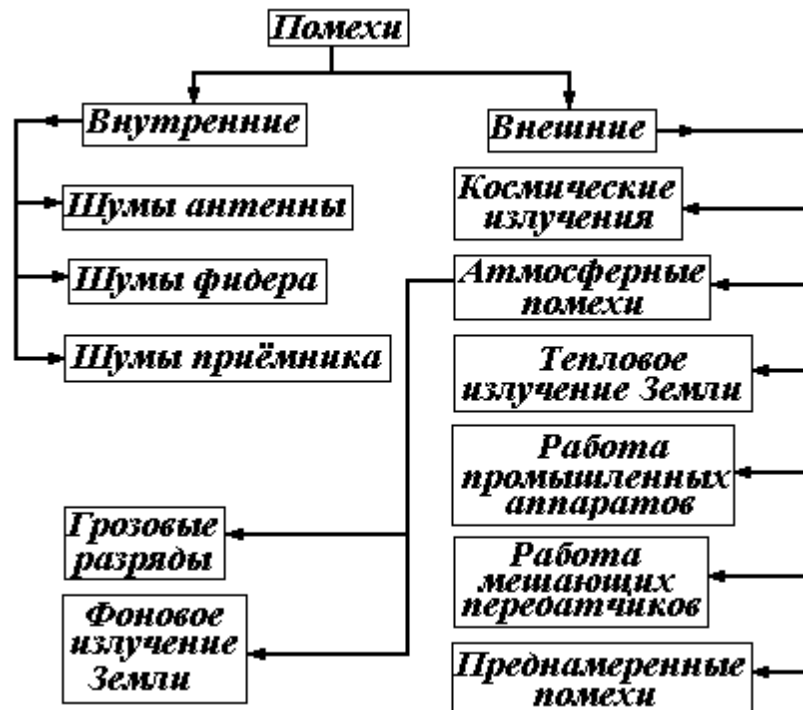
Рисунок 5 – Классификация шумов антенны
