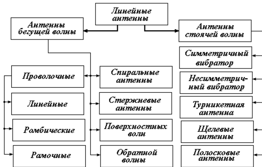
Рисунок 1 – Классификация линейных антенн
