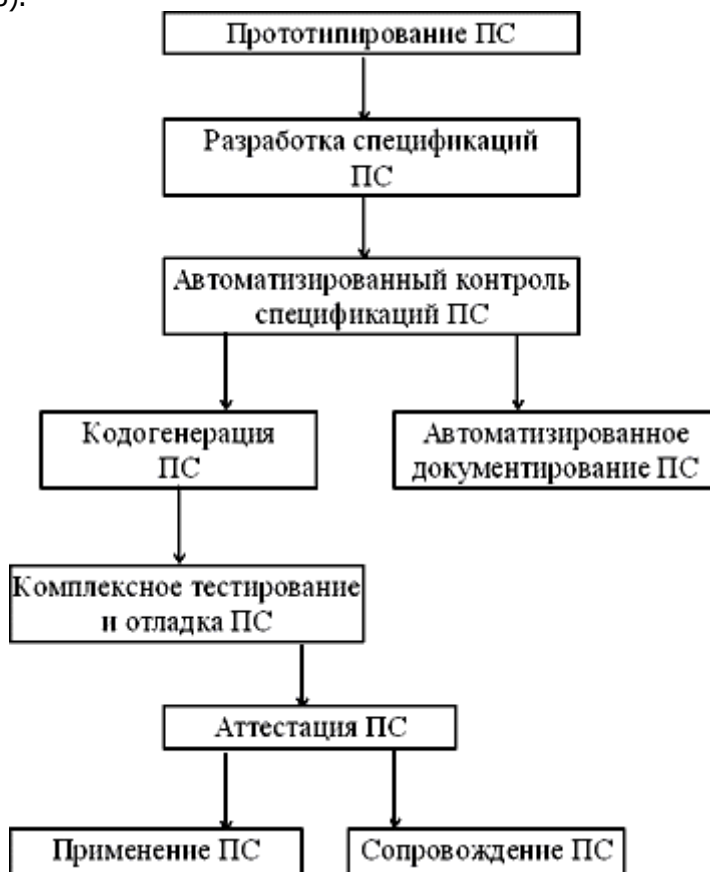
Рис. 3. Жизненный цикл программного средства при использовании компьютерной технологии.
