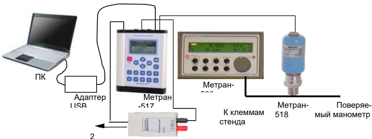
Рис. 3.80. Схема подключений при поверке манометра
