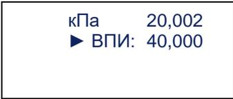
Произведите отчет показаний напоромера и калибратора на 5 значениях: 0%, 20%, 40%, 60%, 80% и 100% диапазона при повышении давления и 80%, 60%, 40%,20%и 0% при понижении давления. По методике определение основной погрешности и вариации производится не менее, чем на 5 значениях давления прямого хода и на 4 значениях давления обратного хода.
