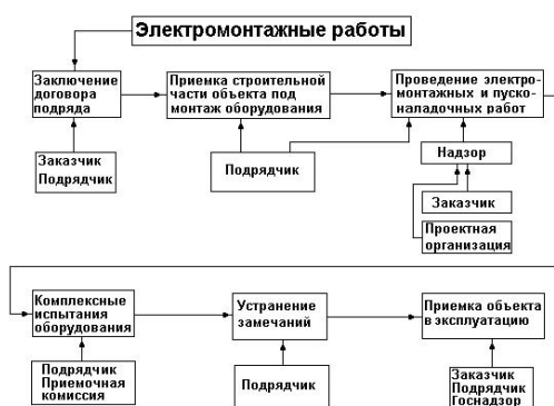
Рис. 2.12 Основные этапы проведения электромонтажных работ
